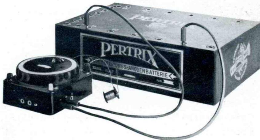
Bild 3 Kleinmeßbrücke mit äußerer Spannungsquelle
