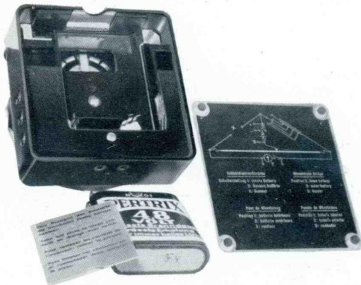
Bild 6 Meßbrücke mit zugänglichem Umschalter
