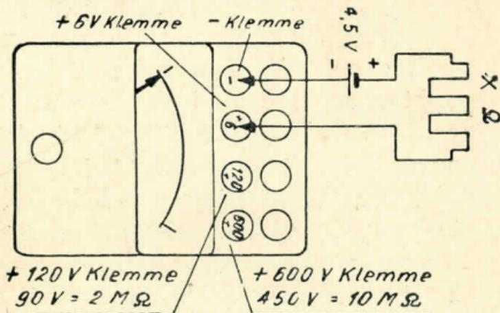
Bei Anlegen einer entsprechend höheren Spannung sind weitere Ohm-Messungen von 0–2 Megohm oder 0–10 Megohm durchführbar. Die obestehende Prinzipschaltung bleibt unverändert bestehen, es ist lediglich diejenige Instrumentenbuchse (+ 120 V oder + 600 Volt) zu wählen, die der angelegten Spannung entspricht, was aus nachfolgender Tabelle hervorgeht.
